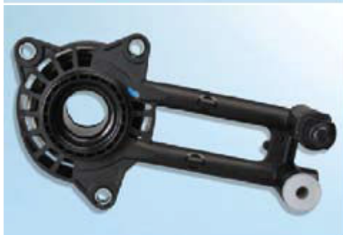
Nouvelle version de 804501 – Corps en plastique
